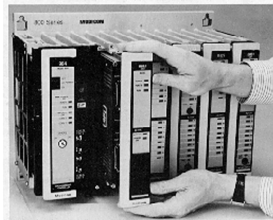
Fig. 9.12. Vista de módulos E/S (Modicon)
